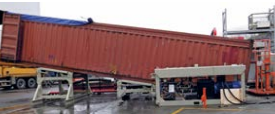
Die Bedingungen am geplanten Einsatzort wurden im 10 ° schräg aufgebauten Container simuliert
